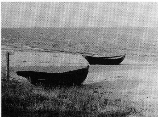
Fig. 4. Hommebåtar från Haväng norr om Vitemölla. Typmässigt blekingsekor, men med den för hommebåtar så typiskt »flata» botten.
