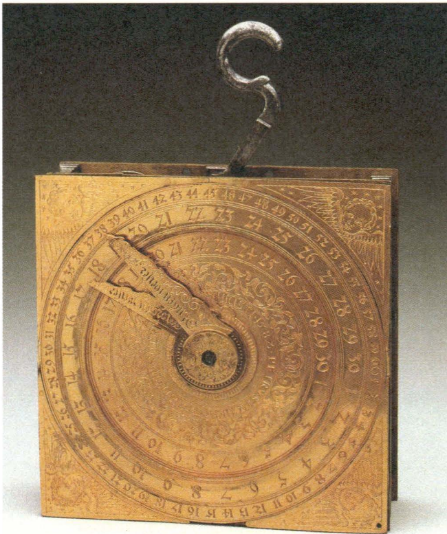
Peter Jachenows hodometer på Nationalmuséet. En latinsk indskrift fortæller, at instrumentet er konstrueret af Jachenow i Schwerin i 1582. Det måler blot 17 x 17 cm med en dybde på 5 cm. De tre visere angiver forskellige længder, der var tilbagelagt. Foto: Nationalmuseet.
